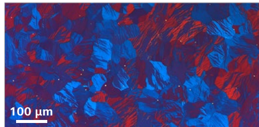
Czysty magnez, 100x, polaryzacja. Zdjęcie dzięki uprzejmości: Allied High Tech Products Inc.
